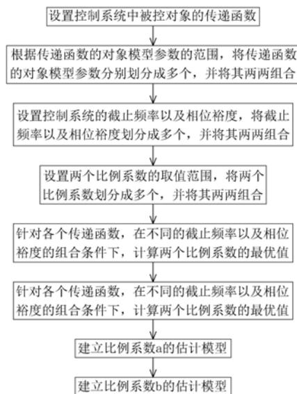
1. 一种PID控制器参数最优比例模型建立方法, PID控制器的控制模型如式3所示:
